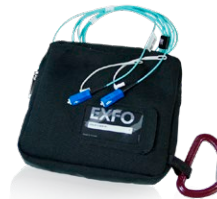
Włókno rozbiegowe EF (SPSB-EF-C30)
